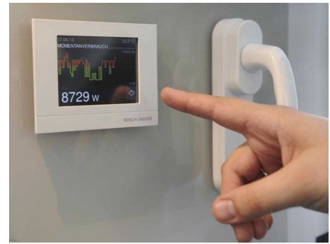
Das Display zeigt den momentanen Energieverbrauch eines "Smart Homes", einem vernetzten Zuhause. (Bild: dpa, Thalia Engel)
